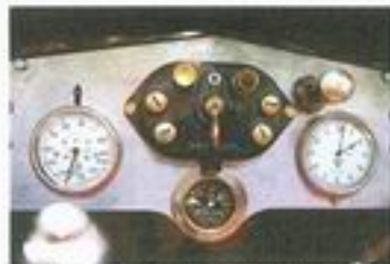
ロバート・ボッシュ製スイッチボードは万有博でもまた正確に機能する。速度計と時計は英国のストリス製。
