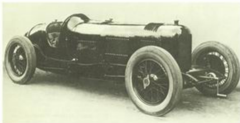
Sopra: la Daimler Grand Prix, otto cilindri con compressore del 1923. Guidata da Maserati partecipò al G. P. d'Italia a Monza ma fu costretta al ritiro per un guasto meccanico. Era stata progettata da Alfieri Maserati.
